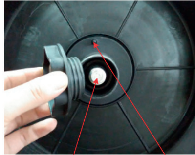
2. Beachten Sie auf die Einstellung der Spannfeder und auf die Positionierungsstütze der Drahttrommel!
