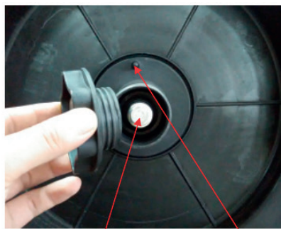
2. Vegye figyelembe a feszítő rugó beállítóját és az huzaldob helyező csapját.
