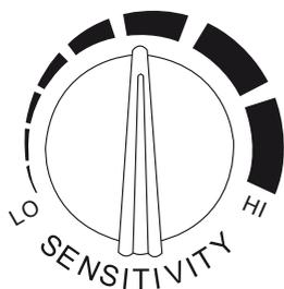
Pred zváraním nastavte citlivosť na vysokú hodnotu, pri relatívne silnom osvetlení (filter sa zatmí). Potom nastavte citlivosť na nižšiu hodnotu, pokiaľ sa filter nevráti do svetlého stavu (nesmerujte kuklu do zdroja svetla, ale k zváranému obrobku). V priebehu zvárania nastavte citlivosť čo najvyššie, aby nebola obmedzená rýchlosť stmievania.
