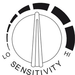
Před svařováním nastavte citlivost na vysokou hodnotu, při střetu s osvětlením (filtr se zatemní, aniž se svařuje), upravte citlivost na nižší hodnotu, dokud se filtr nevrátí do světlého stavu (nesměřujte kukly ke zdroji světla, ale ke svařovanému obrobku). V průběhu svařování nastavte citlivost co nejvýše, aby nebyla omezena rychlost stmívání.
