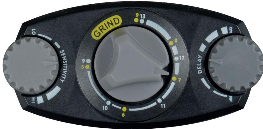
A szabályzó "**GRIND**" - köszörülés állásában az alap (DIN4) sötétség használható, a szabályzó többi állásban az automatikus elsötétedés fokozatait állíthatjuk be a szükséges DIN értékre. A köszörülés funkció aktiválásakor a kazetta belső oldalán egy figyelmeztető jelzőfény villog.
